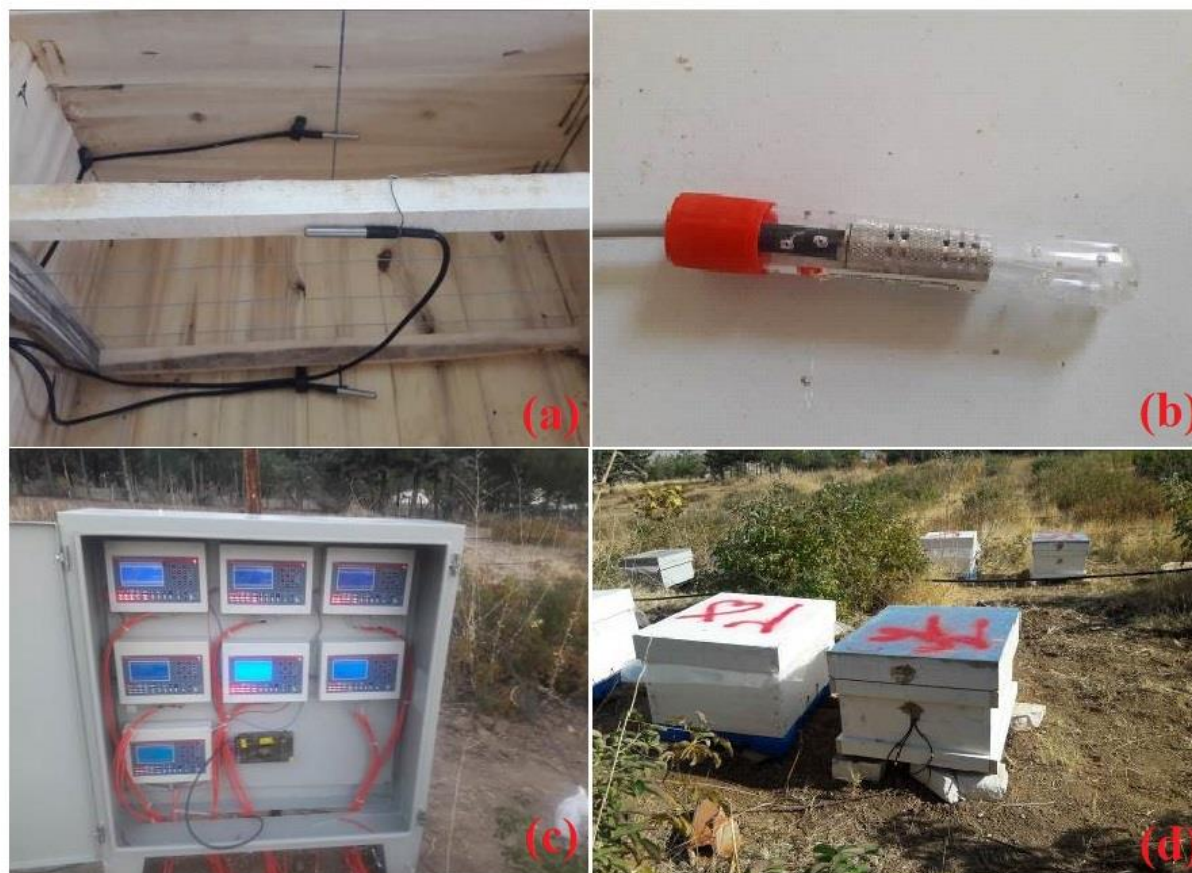
شکل ۳- الف: نصب حسگرهای حرارتی در داخل کندو، ب: حسگر رطوبتی مورد استفاده در داخل کندو، ج: سیستم اتوماسیون ثبت درجه حرارت و رطوبت داخل و بیرون کندوها، د: استقرار کندوها کف باز و بسته در محل اجرای آزمایش
